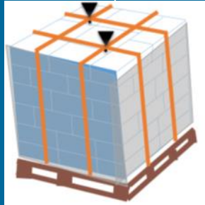
Afb. 4 Pallet met folie en omsnoeringsband
